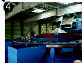
3 Dépôt des déchets du bac jaune sur un tapis roulant
